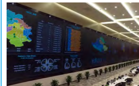
Крупнейшая в мире видео-стена: 324 80-дюймовых светодиодных куба DLP и система DVCS (Китай)
