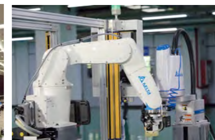
Роботы-манипуляторы ускоряют процесс функционального тестирования роботов SCARA
